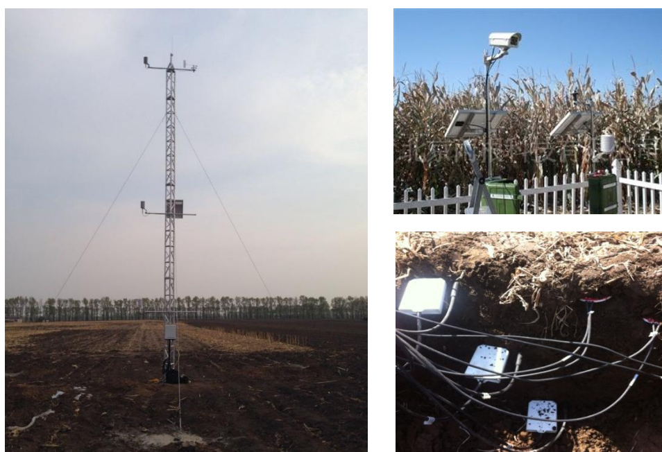
图 1. 气象塔、物候监测系统以及土壤温湿度传感器的布设
